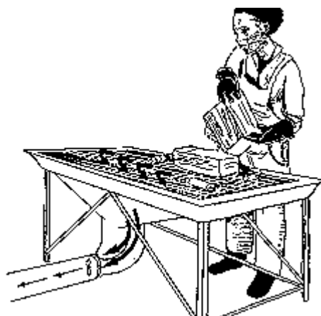
Рисунок 94б. Другим методом локальной вентиляции является засасывание вредной пыли через отверстия в столе прежде, чем эта пыль достигнет дыхательной зоны
