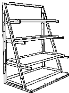
Рисунок 8в. Вертикальный стеллаж. Металлические прутья или бруски различного профиля могут с пользой храниться на ограниченной территории или с местом работы. Плоские полки, в виде подносов, обеспечивают возможность хранения маленьких деталей.
