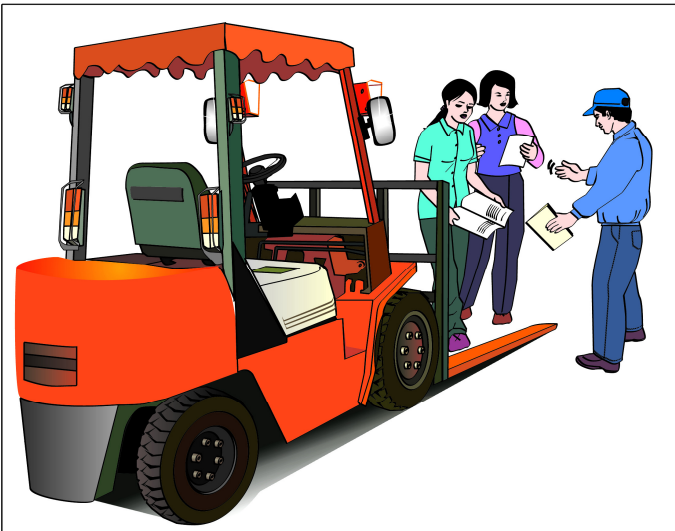
49.b ábra Az ellenőrző jegyzék alapján a napi használat előtt ellenőrizzük, hogy a villás targoncák biztonsági be- rendezései és a közlekedési utak használhatók-e.
