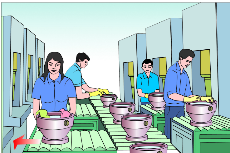
6.d ábra Passzív szállítósor nehéz motoröntvények megmunkálási magasságban történő mozgatusára.
