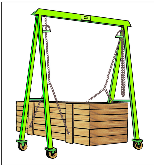
9.a ábra A hordozható portáldaru megbízható, biztonságos és könnyű eszköz a nehéz terhek minimális emelésével rövid távolságra történő mozgatására.
