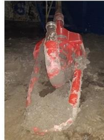
Рис. 3 – вертлюг після падіння
