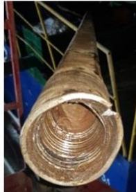
Рис. 4 – квадрат після падіння (з пошкодженнями)
