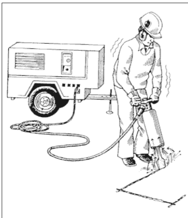
Figura 51. Controlo de ruído dos compressores: mantenha as coberturas fechadas, utilize um silenciador ou um martelo pneumático e use protectores auriculares.
