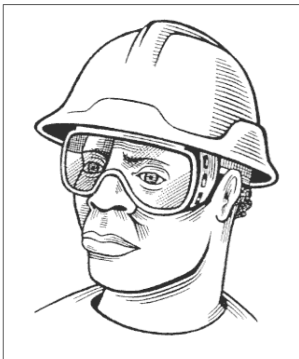
Figura 53. A protecção ocular tem de ser adequada, confortável e estar disponível para incentivar os trabalhadores ao seu uso.
