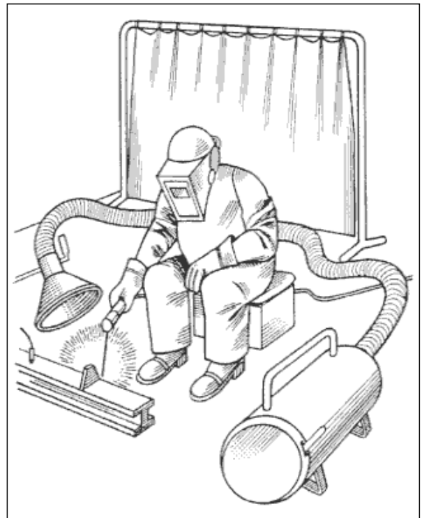
Figura 45. Soldadura com arco: o local de trabalho está ligado à terra, o soldador usa equipamento de protecção individual e o local de trabalho está protegido.
