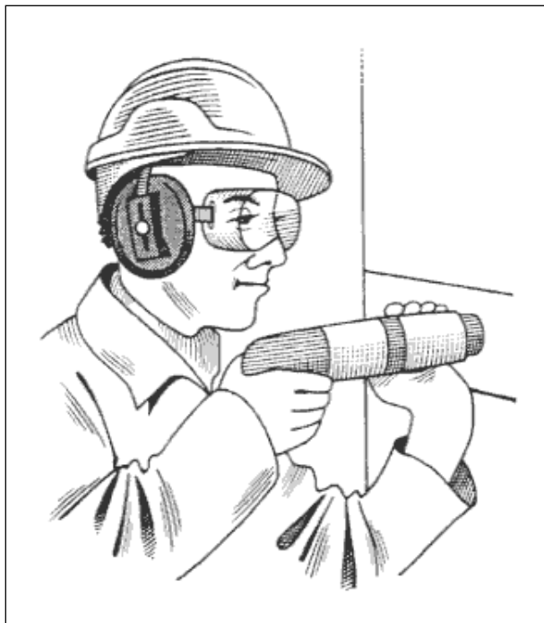
Figura 42. Utilização de protecção auditiva e ocular pelo operador de uma pistola de cartucho, que também usa capacete.
