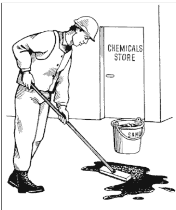
Figura 50. Derrame de produto químico, absorvido com areia seca.
