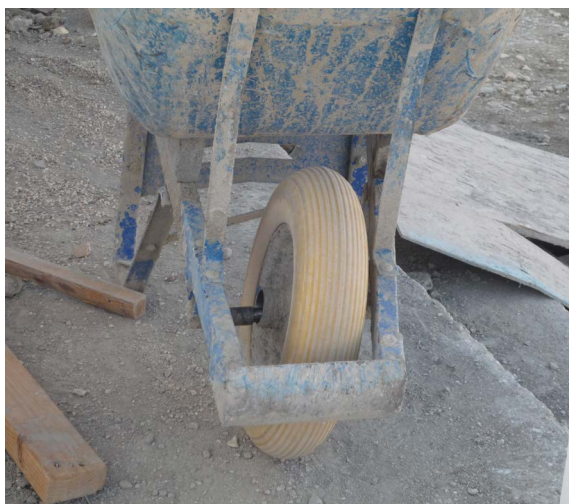
Ilustración 50. Carretilla con cojinetes en mal estado
