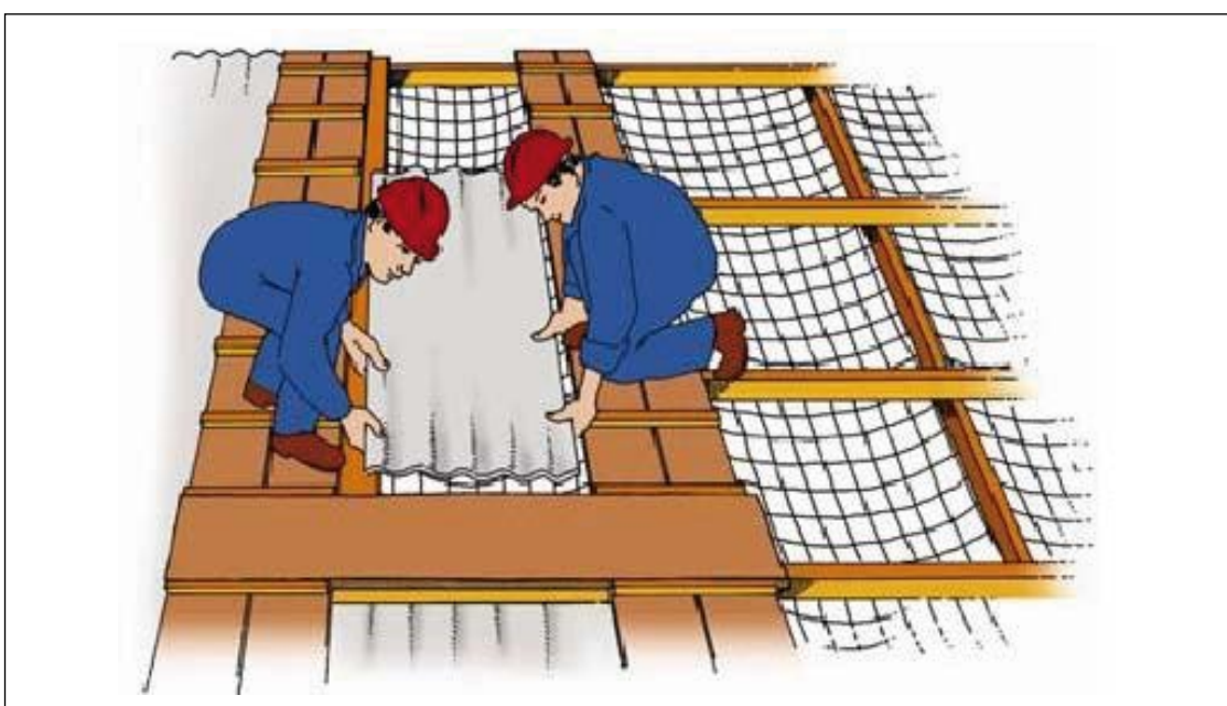
Ilustración 22. Redes de seguridad instaladas
