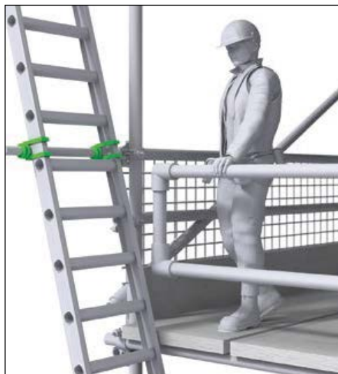
Ilustración 12. Escalera posicionada y afianzada correctamente junto a la plataforma de acceso
