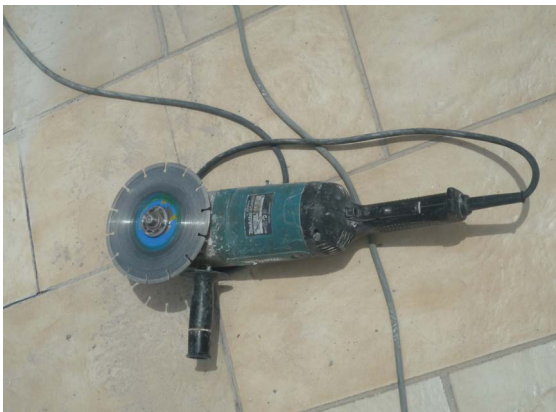
Ilustración 48. Cortadora/esmeriladora manual sin dispositivo de protección
