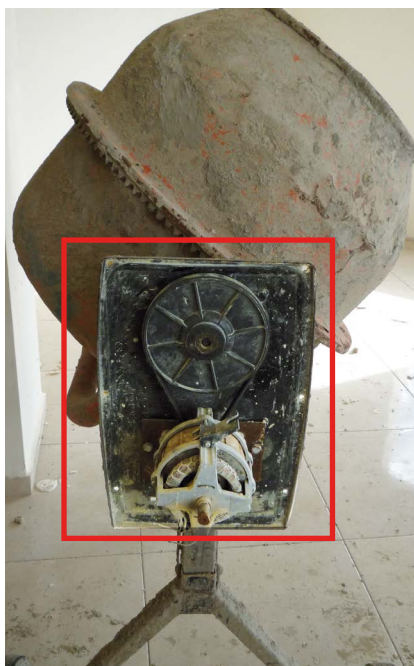
Ilustración 45. Mecanismo de transmisión de faja y poleas de una mezcladora de hormigón sin el dispositivo de protección
