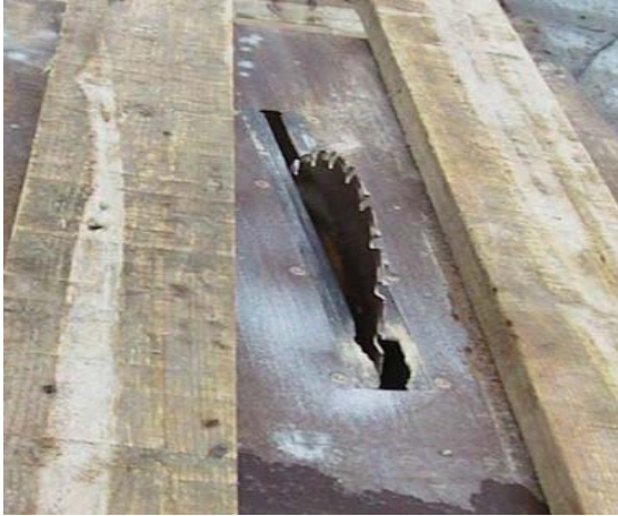
Ilustración 46. Sierra circular sin dispositivo de protección
