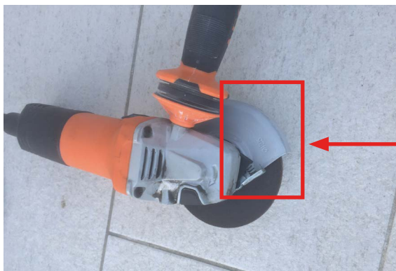
Ilustración 49. Cortadora/esmeriladora manual protegida correctamente
