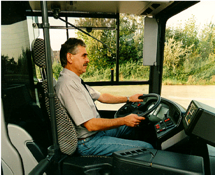
Рис. 102.7. Ергономічно оптимізоване та стандартизоване робоче місце водія у автобусах в Німеччині
