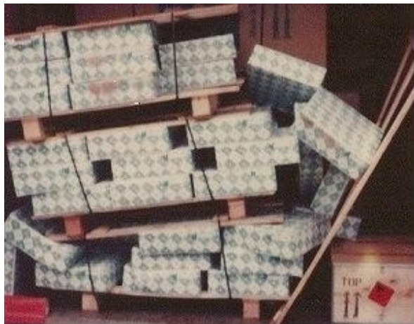
Figure 2.2. Cargaison mal assujettie
