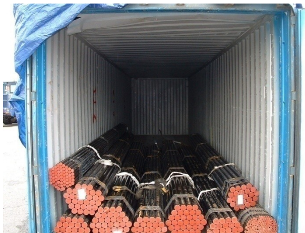
Figure 2.3. Paquets de tuyaux d'acier non assujettis
