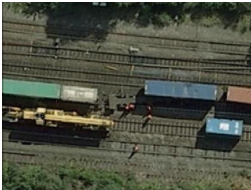
Figure 1.8. Déraillement de wagons porte-conteneurs
