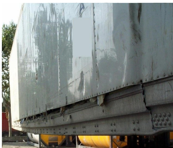
Figure 2.1. Détachement du longeron latéral inférieur
