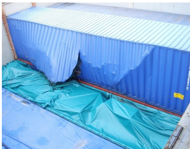
Figure 2.5. Paroi latérale endommagée
