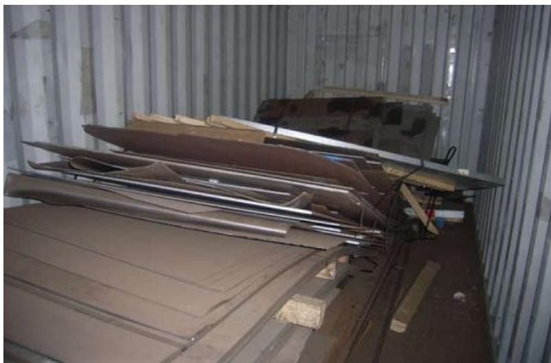
Figure 1.9. Les tôles d'acier affalées
