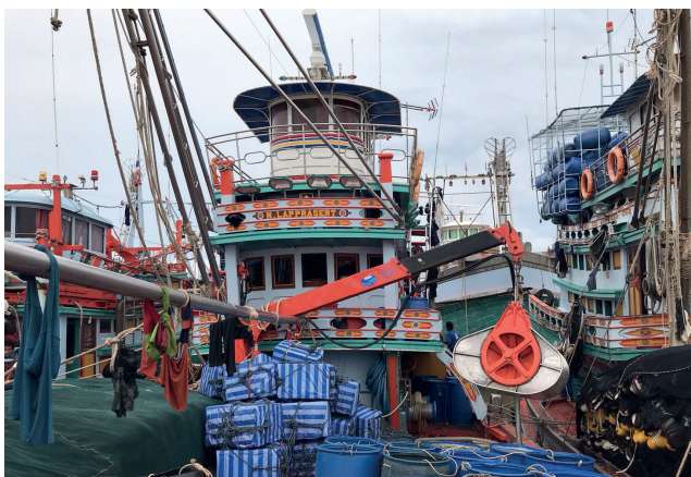
ภาพที่ 3: เครื่องมือกู้วน (พาวเวอร์บล็อก) บนเรือก่อนออกทะเล (ภาพ: SEAFDEC)
