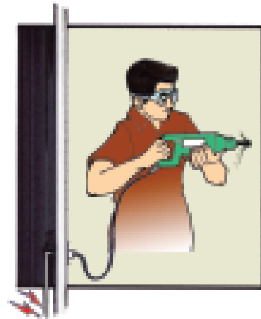
Hình 28: Tất cả thiết bị điện cần phải nối đất đúng kỹ thuật. Cần sử dụng một dây nối đất độc lập để nối từ máy với cực tiếp đất.
