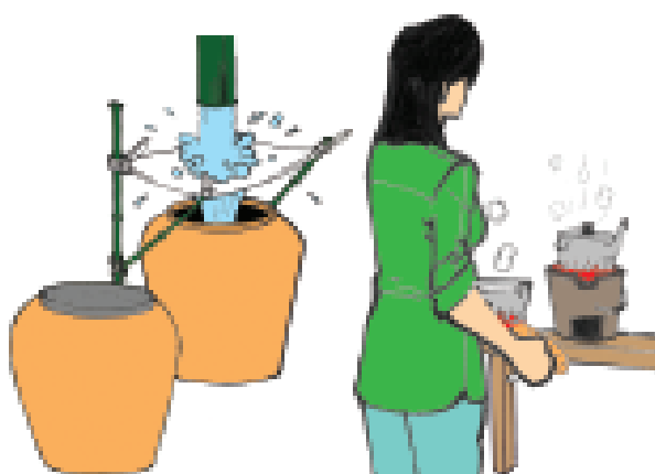
Hình 74: Nước mưa hay nước dưới lòng đất phải được lọc và đun sôi để tránh khả năng ô nhiễm.
