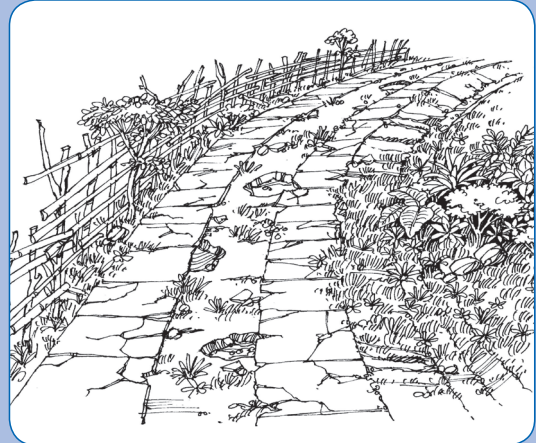
Kondisi jalan setelah 3-5 tahun tanpa pemeliharaan
