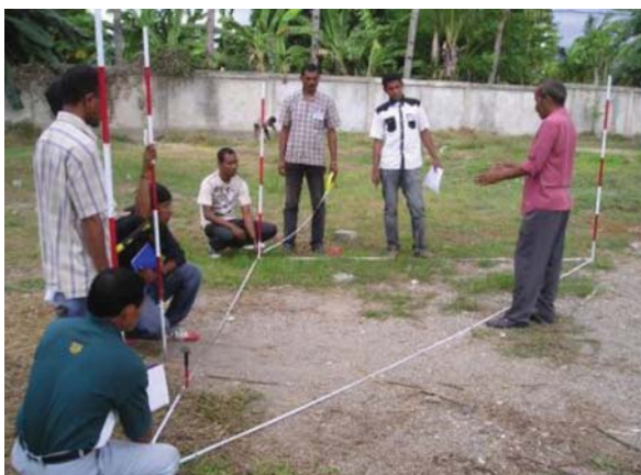
Gambar 3: Merancang sudut 90° dari garis tengah
