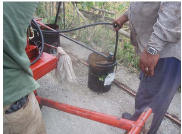
Gambar 1: membersihkan penyemprot emulsi setelah digunakan
