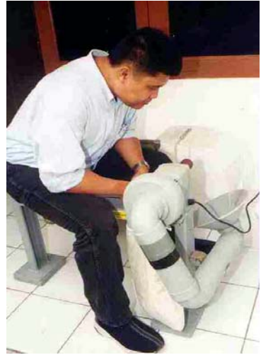
Foto 1.3: Mesin gerinda yang dilengkapi dengan kantong debu, pelindung mata dan tempat duduk yang dikembangkan oleh Institut Teknologi Bandung (ITB) bekerja sama dengan ILO-IPEC Footwear Programme.
