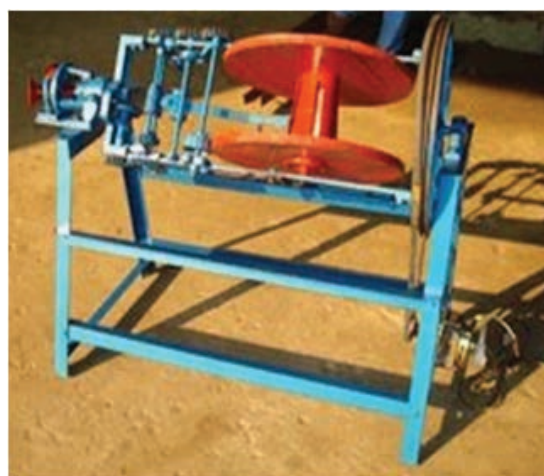
Зураг 3. Ноосоор дээс, хошлон хийдэг цахилгаан төхөөрөмж, 2012 он. Эх сурвалж: http://zuvluh.mn/equipment/equipment
