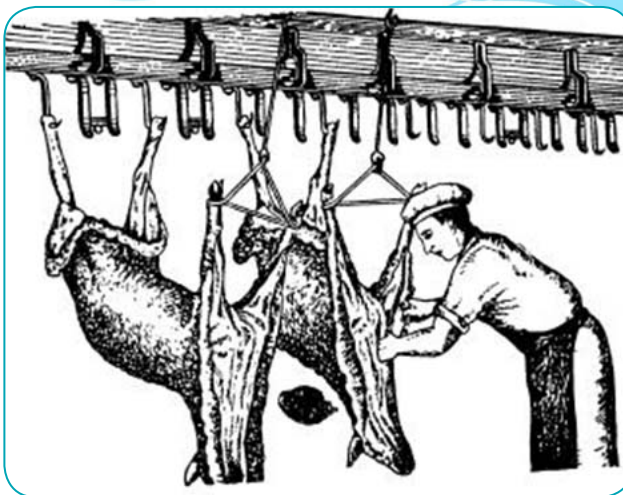
Зураг 3. Үхэр ба хонийг өлгөх төхөөрөмжид өлгөөд хуулж буй байдал
