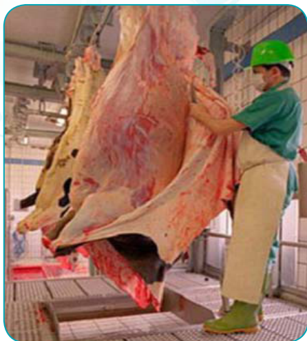
Зураг 3. Үхэр ба хонийг өлгөх төхөөрөмжид өлгөөд хуулж буй байдал
