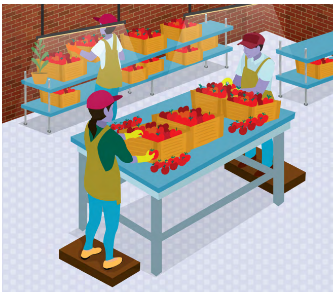
► Figura 7a. Tarima para que el trabajo de pie de una persona más pequeña se ajuste a la altura del trabajo al nivel del codo
