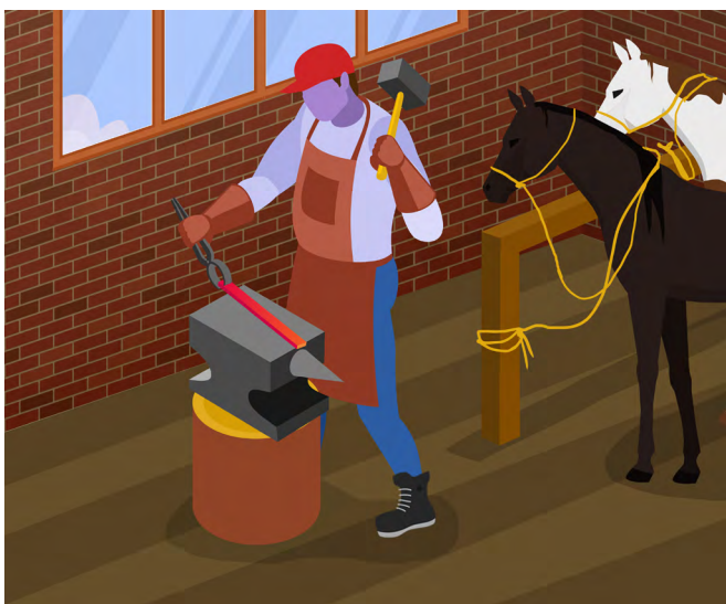
► Figura 7c. Altura de trabajo inferior a la altura del codo cuando se requiere ejercer una mayor fuerza
