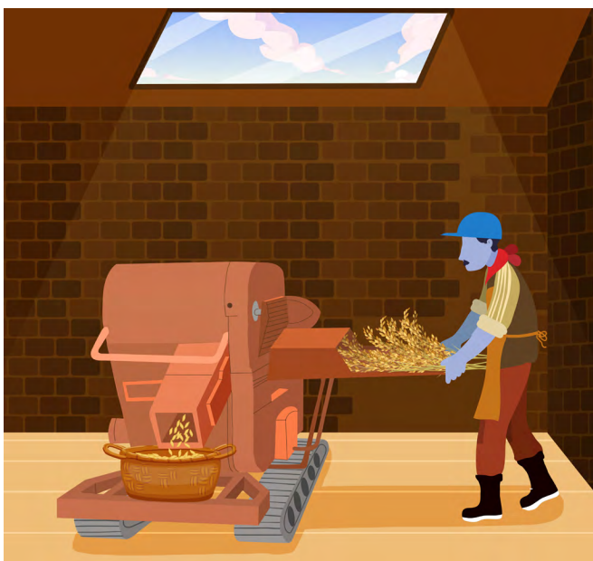
► Figura 14a. Dispositivo de alimentación conectado a una máquina de trilla que toma gradualmente los manojos de arroz y separa los granos
