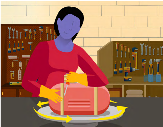
► Figura 10c. Mesa giratoria para minimizar el movimiento manual de objetos pesados
