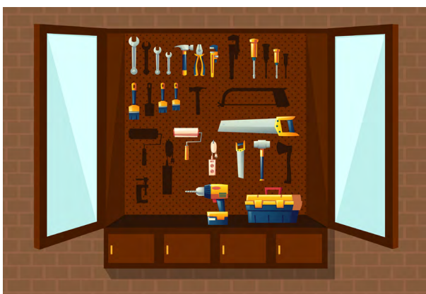
► Figura 3a. Vitrina de madera para colgar las herramientas, con la forma de cada herramienta claramente marcada
