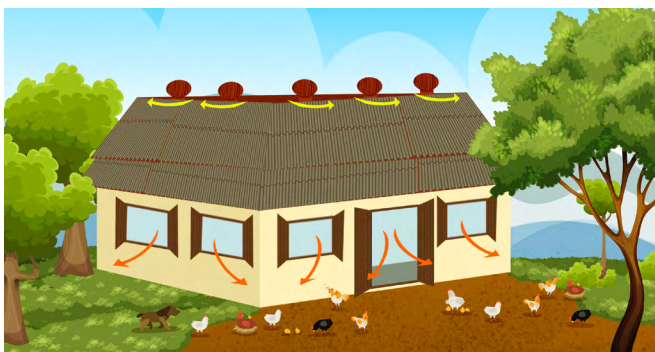
► Figura 17a. Puerta abierta y ventanas sin obstáculos, para mejorar la ventilación natural
