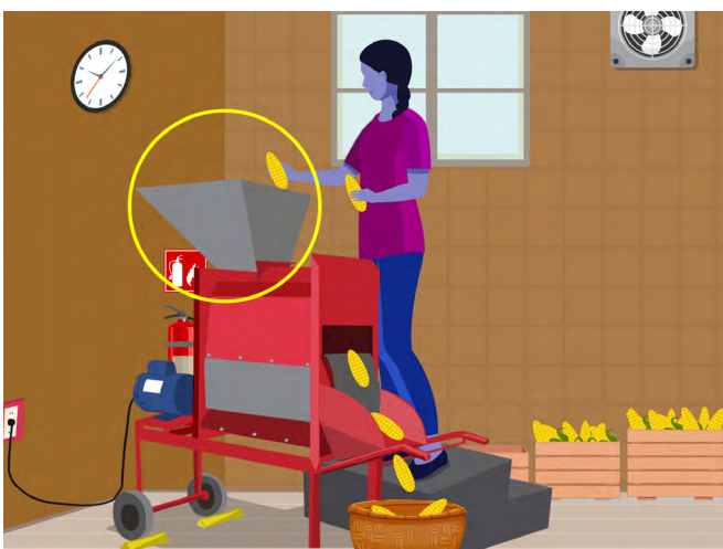
► Figura 14b. Alimentación de la tolva desde una tarima para ajustar la altura de trabajo y permitir una buena postura
