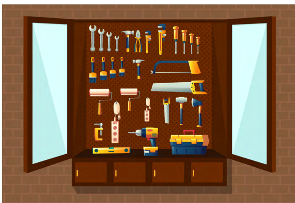
► Figura 3b. Armario para colocar las herramientas: alicates, martillos, sierras, etc., deben colgarse cuidadosamente en ambos lados, con los filos hacia la pared y en ubicaciones claramente etiquetadas
