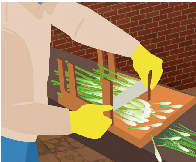
► Figura 11b. Sujeción sencilla para labores de corte fáciles y seguras que garantiza la consistencia del producto
