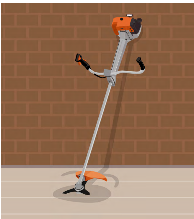
► Figura 13b. Protector especial en una herramienta de mano permite prevenir accidentes y lesiones al operador y a las personas cercanas
