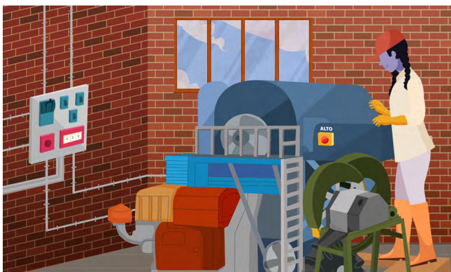
► Figura 16b. Cables eléctricos, panel de control e interruptores debidamente asegurados a la pared, cubiertos y forrados
