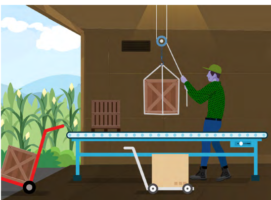
► Figura 6c. Elevador manual para levantar cargas pesadas (polipasto)
