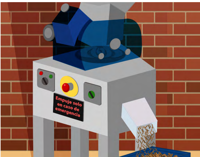
► Figura 15b. Parada de emergencia de color rojo en el panel de control rotulada, grande, visible y legible
