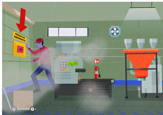
► Figura 15a. Botón rojo de parada de emergencia, grande, visible, de fácil acceso y de rápido alcance para las manos
