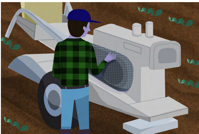
► Figura 13a. Protector de seguridad fabricado con materiales disponibles localmente. Por ejemplo, el uso de una malla metálica permite observar la operación de forma segura
