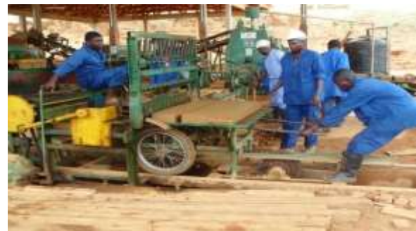
Briqueterie semi-industrielle de la MIPROMALO en fonctionnement (Nkolbisson, Yaoundé, Cameroun) : approche HIMO prise en compte
