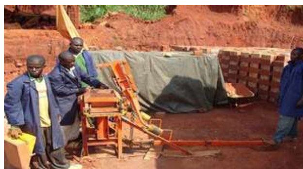
Figure 3 : Presses à briques de terre comprimée (BTC) distribuées aux municipalités dans le cadre du PGT2D, MIPROMALO 2012 (a) et presse en cours d'utilisation dans un chantier (b)
