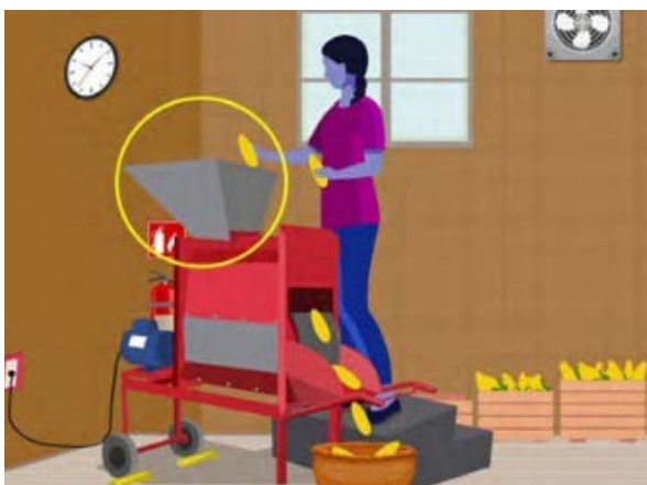
► Зураг 14б. Тавцан дээр зогсож юүлүүрт түүхий эд, материал хийх нь ажлын өндрийг тохиромжтой түвшинд байлгаж, зөв байрлалаар ажиллах боломжийг олгодог.
