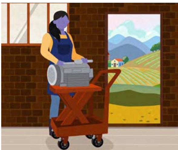
► Зураг 6б. Хүнд жинтэй зүйлийг тохиромжтой түвшинд өргөхөд ашиглаж болох гар ажиллагаатай төхөөрөмж.
