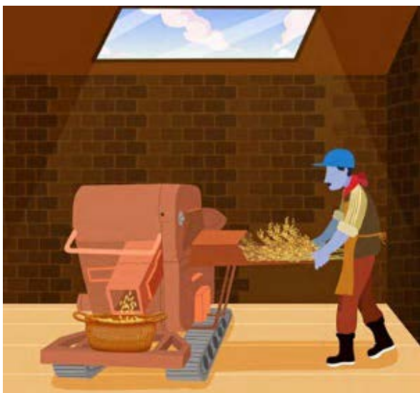
► Зураг 14а. Будаа цайруулах машинд бэхэлсэн оруулах төхөөрөмж. Энэ нь үр тариаг аажмаар машинд оруулж байна.
