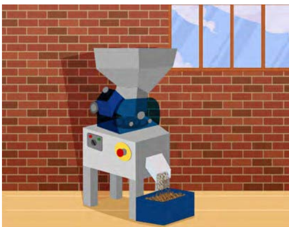
► Зураг 14в. Тээрэмдэх машинд зориулсан юүлүүр хэлбэртэй оруулах төхөөрөмж.
