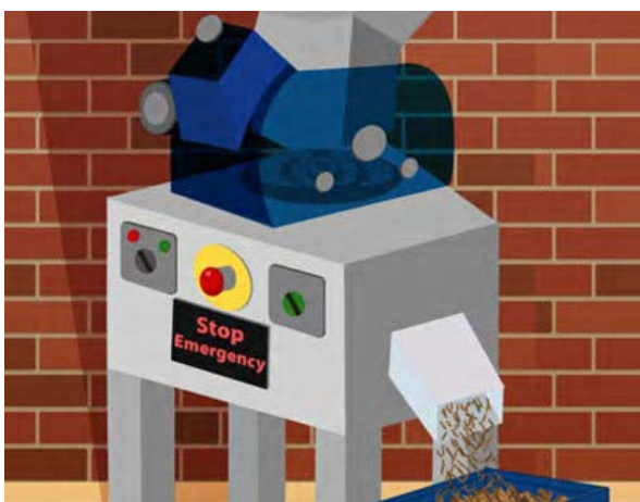
► Зураг 15б. Хяналтын самбар дээрх улаан өнгийн ослын товчлуур. Том хэмжээтэй, тод харагдахуйц, тодорхой тэмдэглэсэн, уншигдахуйц байна.
