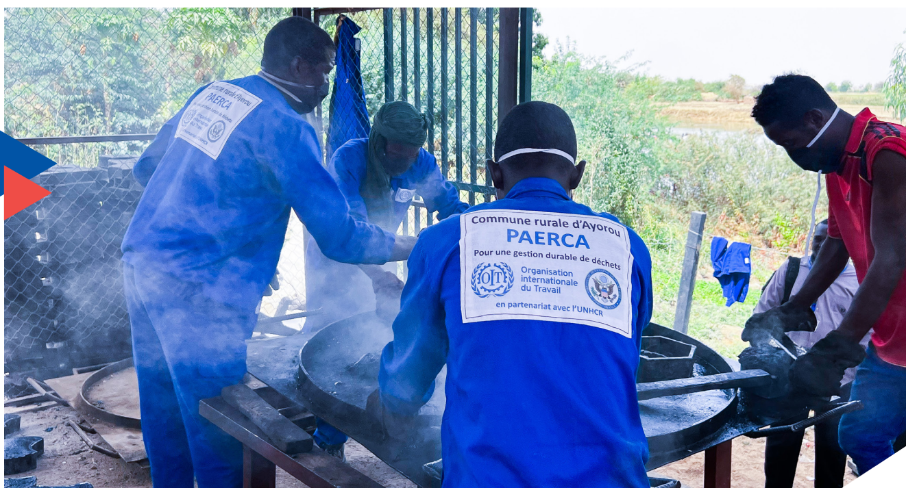
Transformation de déchets en pavés par les bénéficiaires du projet PAERCA
