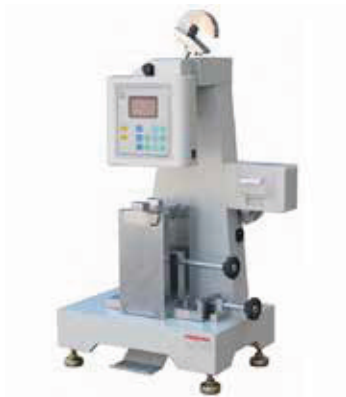
Essai de choc Charpy et Izod
