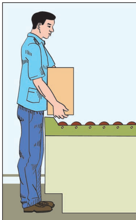
图5b. 滚轮或者输送带可减少手工搬运的距离。滚轮或者输送带设置的高度应使劳动者在操作工件时不弯腰为宜，并留有足够的空间，能确保脚和身体靠近滚轮或者输送带。
