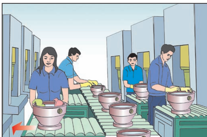
图6d. 一条用于运输重型发动机铸件的被动式输送线。
