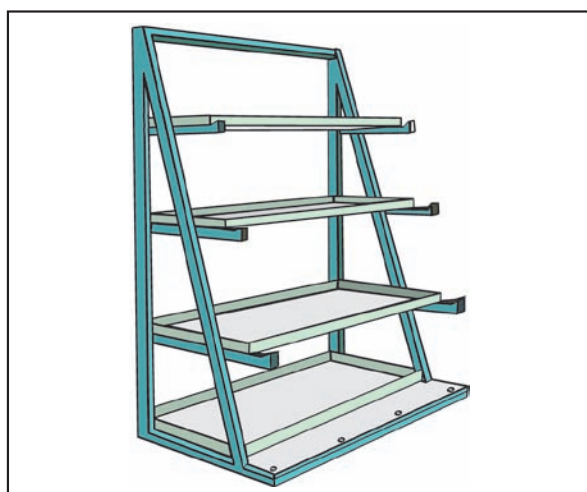
图8c. 垂直货架。不同形状的金属杆和棒可有效地存放于狭窄区或者工作附近。托盘状货架可安放小件物料。
