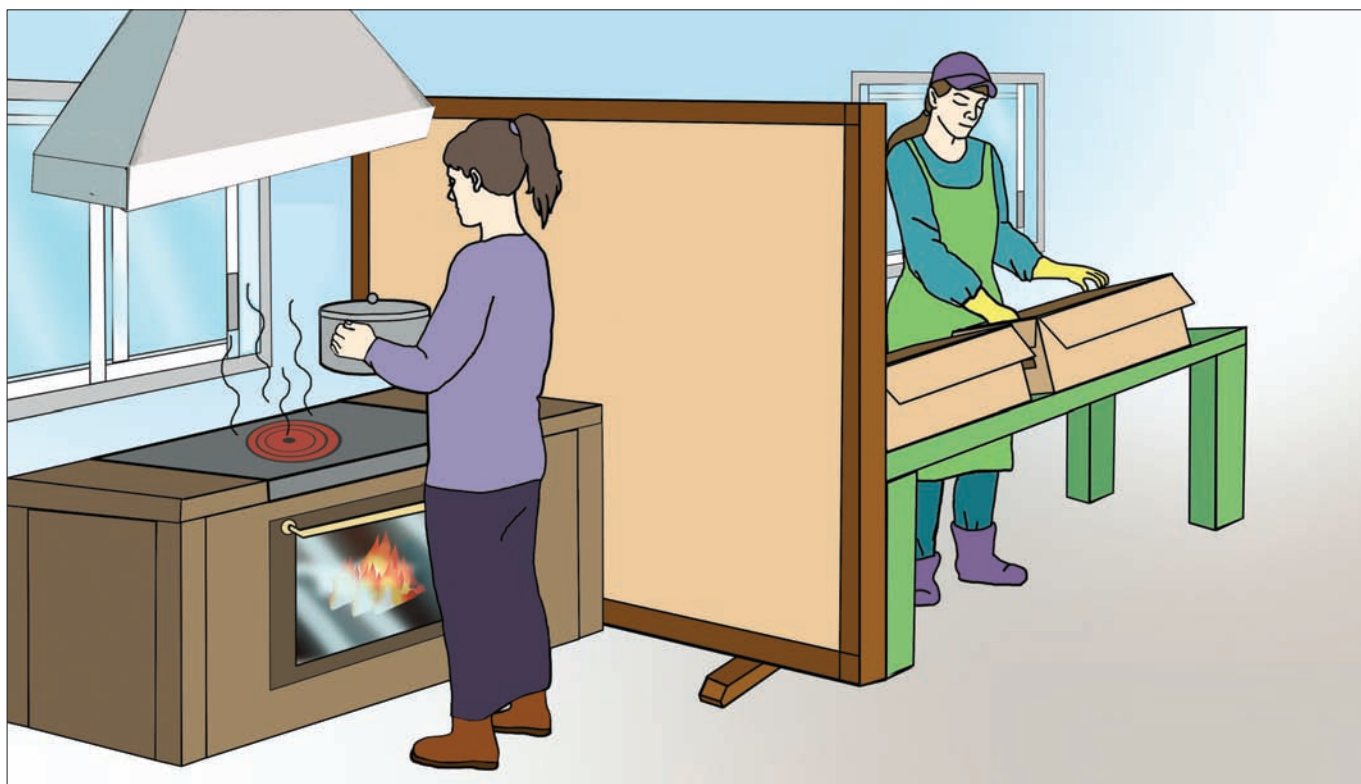
图 51b. 使用屏风或屏障保护劳动者免受来自高温设备及热墙的热辐射
