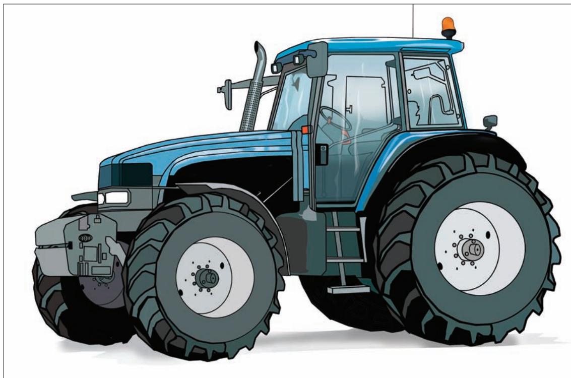
图 45a. 所有的拖拉机都应具备翻车保护结构，将其与安全带并用，可避免大多数死亡事故
