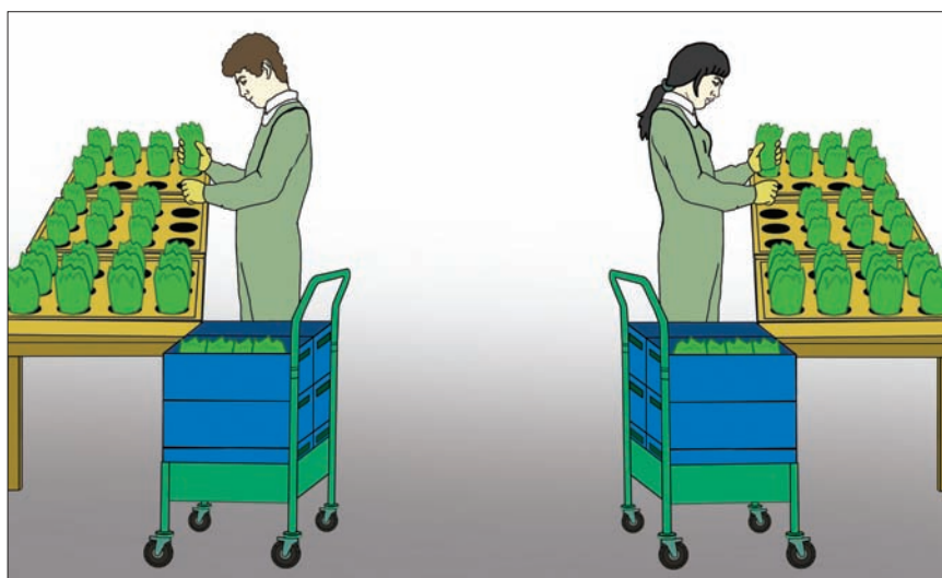
图 18b. 安排工作台和手推车，使劳作时不用弯曲或扭曲身体
