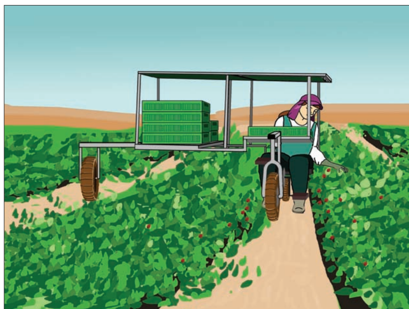
图 15d. 一种设计良好的移动式工作台，盛放农产品的篮子可放置在工作台上劳动者易取处
