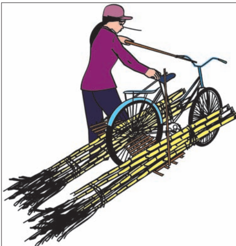
图 4b. 改良自行车，使其可作一种运输工具
