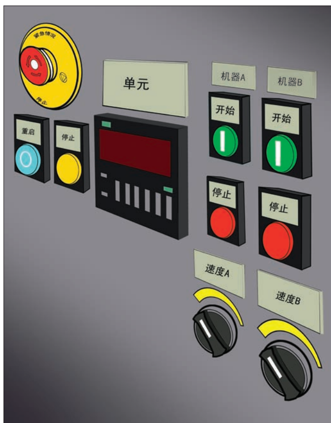
图 40c. 一种配有醒目的控制器、开关和显示器的线路板；控制器、开关和显示器均用当地语言清晰地写明
