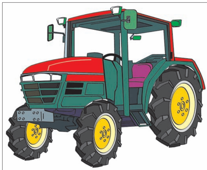
图 48b. 反光镜可增大驾驶员的前和后视野
