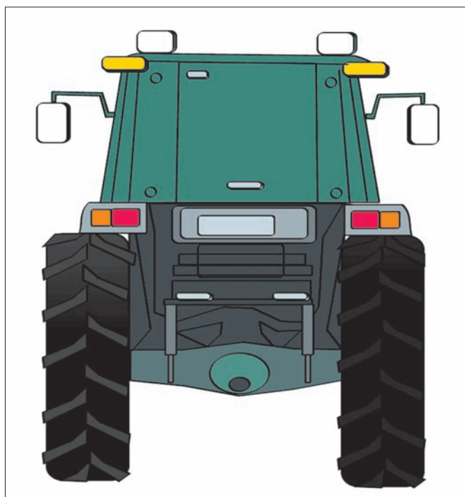
图 42b. 车辆两侧的侧反光镜、反光板和附加灯光
