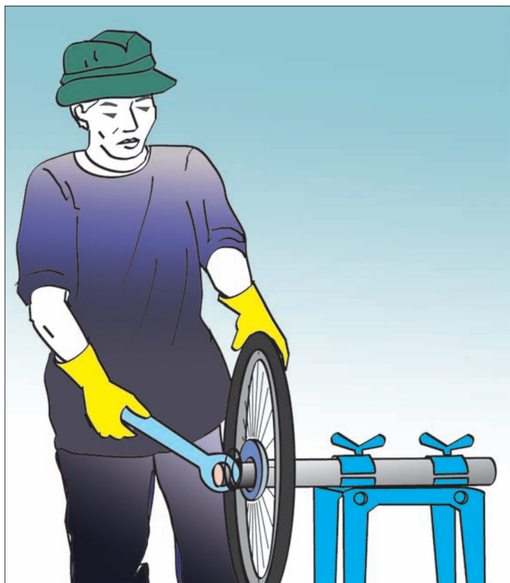
图 19c. 当拆开轮毂或轮轴以维修或检修时，使用固定装置固定住轮毂或轮轴
