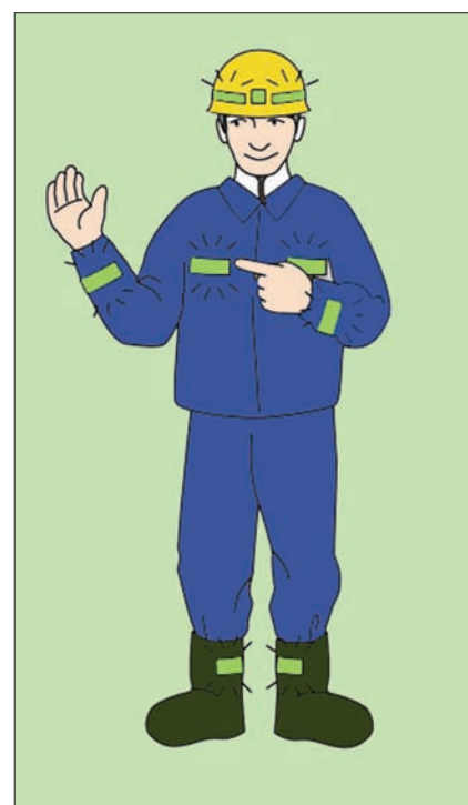
图 42d. 工作服和头盔上的反光贴
