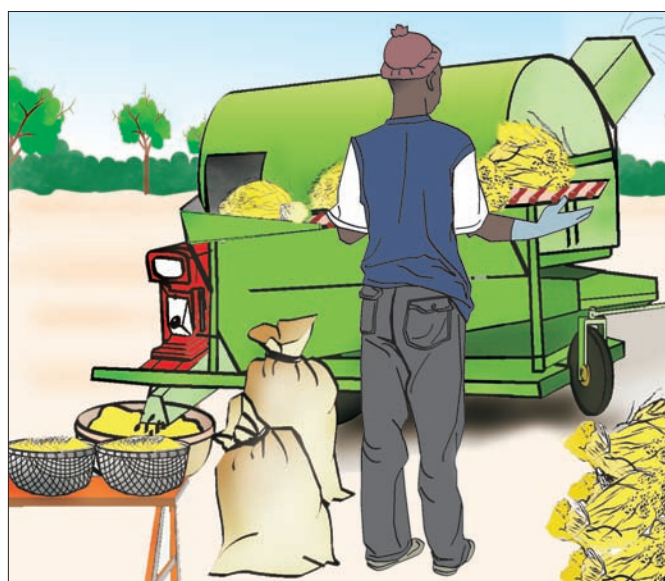
图 31b. 可将农机工具的进料装置设计得更高，这样，劳动者就可在一种自然立姿的状态下操作
