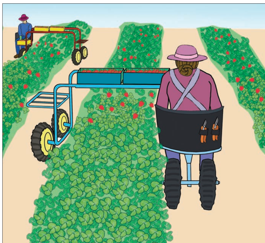
图 5c. 一种舒适的草莓采摘车，车子前导轮架上配有工作用的座位
