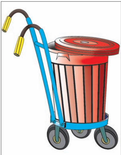
图 10f. 一种搬运废物桶的专用手推货车
