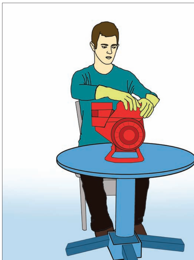
图 27b. 一个旋转的工作架易于劳动者从不同方向操作工件
