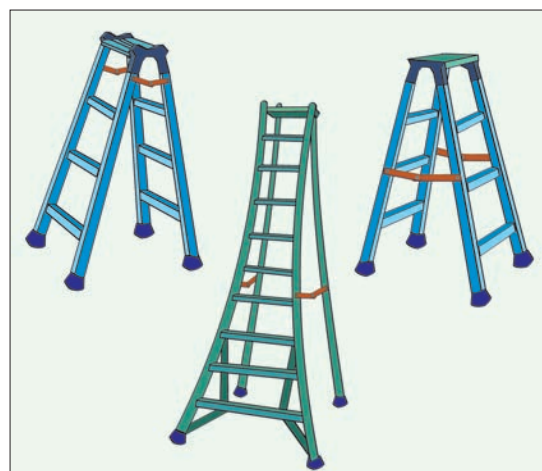
图 28b. 已有各种形状的便携式梯子在实践中应用，使用安装有避免突然倒塌装置的梯子
