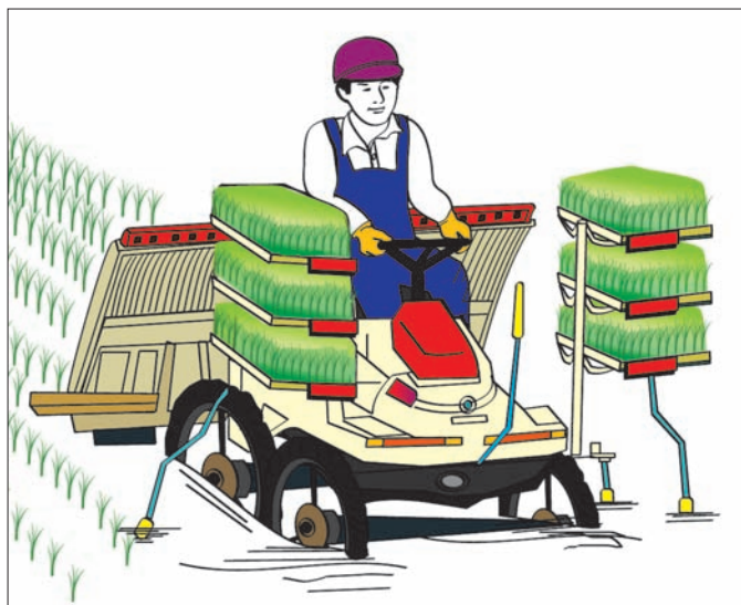
图 48a. 确保驾驶座上有良好的视距，良好的视距是这台小型插秧机的特征之一，使该机器易于操作
