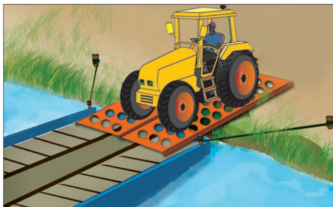
图 44c. 提供稳固的平台，使之成为车辆上、下船的通道
