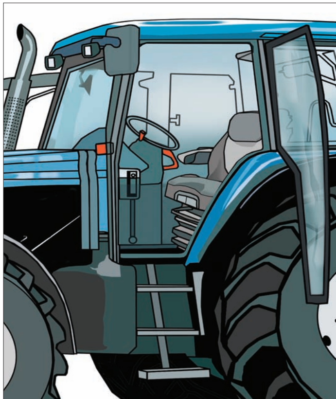
图 45b. 容易进入驾驶座、合适的座位、免受天气影响及减少噪声和振动的措施，对于预防跌落、最大限度地提高座位舒适性并避免误操作很重要
