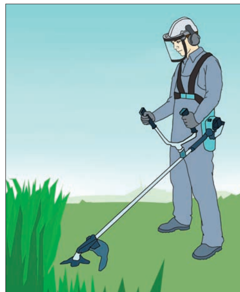
图 24b. 使用一种手持收割机，减少劳动者手臂和手部肌肉的工作负担，在工具上安装一种牢固手柄，以保证抓握安全
