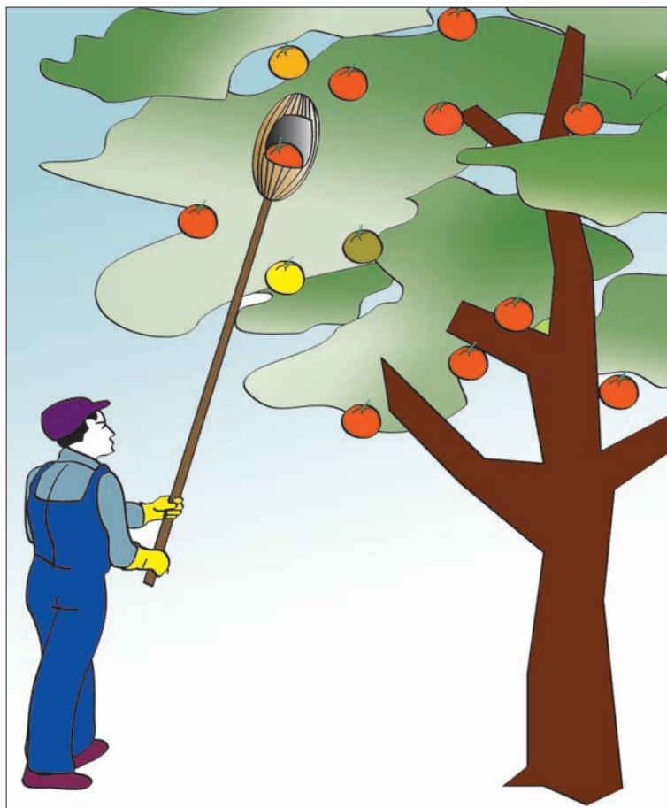
图 20a. 通常，简单装置可将高架平台的操作替换为在地面上的、更安全的操作
