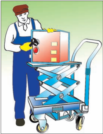
图 11d. 一种将重物提升到工作面高度的手动设备
