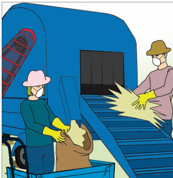
图 31a. 输送带样式的进料装置，可将稻束输送到脱粒机危险部位
