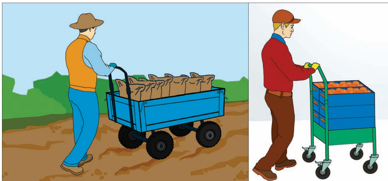
图 5a. 在不平整的道路上，与小轮子的手推车相比，大轮子的手推车更容易推或拉
