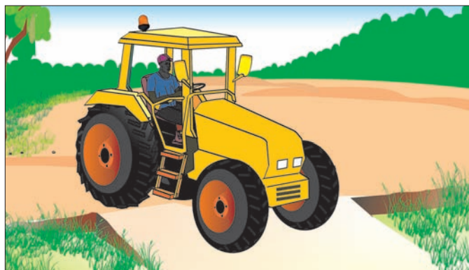
图 44a. 确保农用车的通道足够宽，并尽量消除凹凸处
