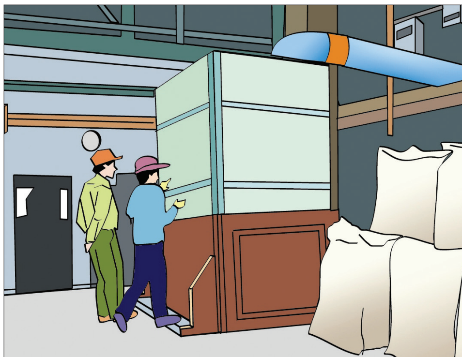
图 56a. 选择一种有良好密闭装置，并且与排风系统相连接的机械
