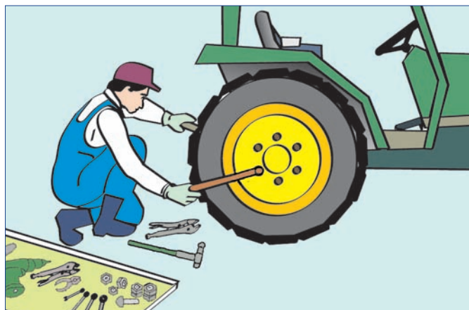
图 34b. 特别要注意农机工具的危險部分，维修期间，应确保关闭农机工具
