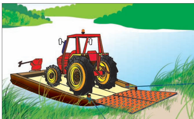
图 2e. 使用斜坡可将车辆安全地装载到船上
