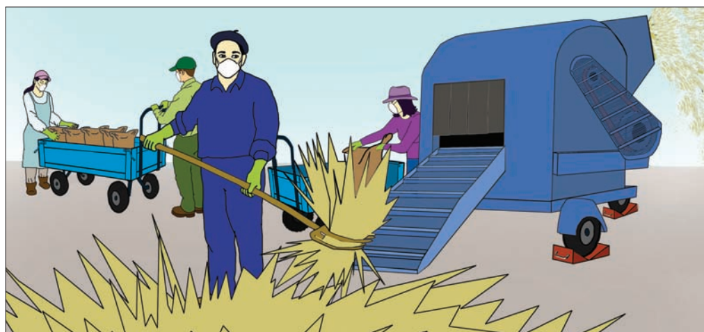
图 32a. 使用楔子固定农机工具的轮子，或使用有履带的农机工具
