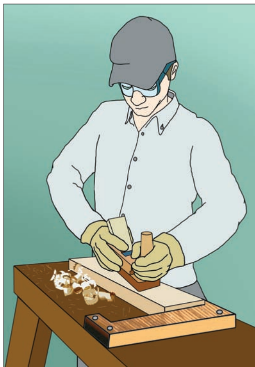
图 19a. 一个低成本的木制固定装置，用以固定住刨削的工件
