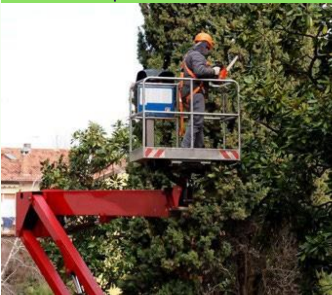
► Hình 38. Một NLĐ sử dụng sàn công tác di động trên cao để làm việc an toàn trên
