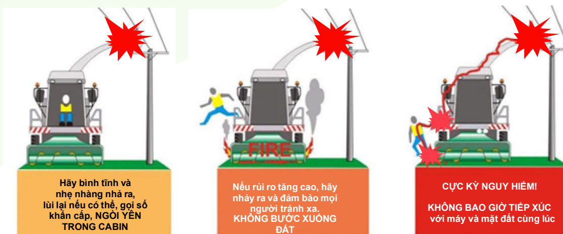
► Hình 48. Các hành động cần thiết nếu máy, thiết bị tiếp xúc với đường dây điện trên
