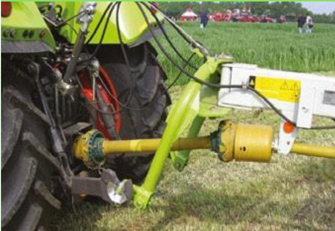
► Hình 29. Khớp nối trực trích công suất được bảo vệ cho máy kéo và nông cụ.
