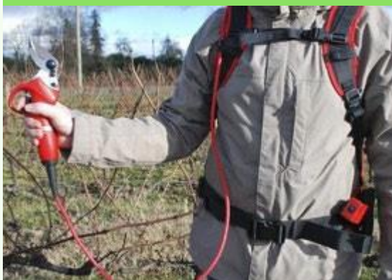
► Hình 47. Một NLĐ sử dụng kéo tia cây chạy bằng điện
