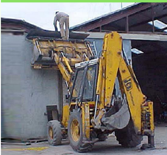
►Hình 35. Sàn công tác gắn trên một máy di động có thanh chắn bảo vệ xung quanh.
