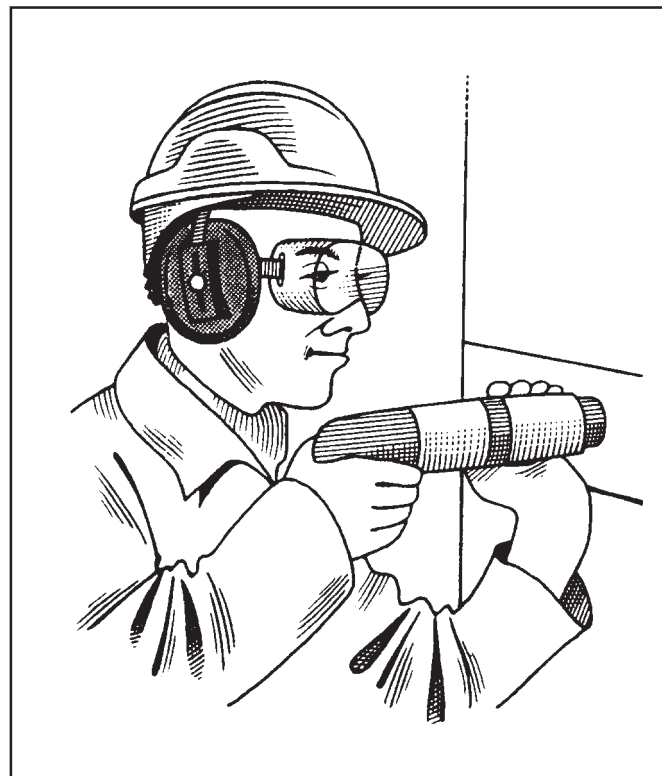
Figura 42. Protección de ojos y oídos durante el uso de una pistola de cartuchos. El operador lleva también casco.
