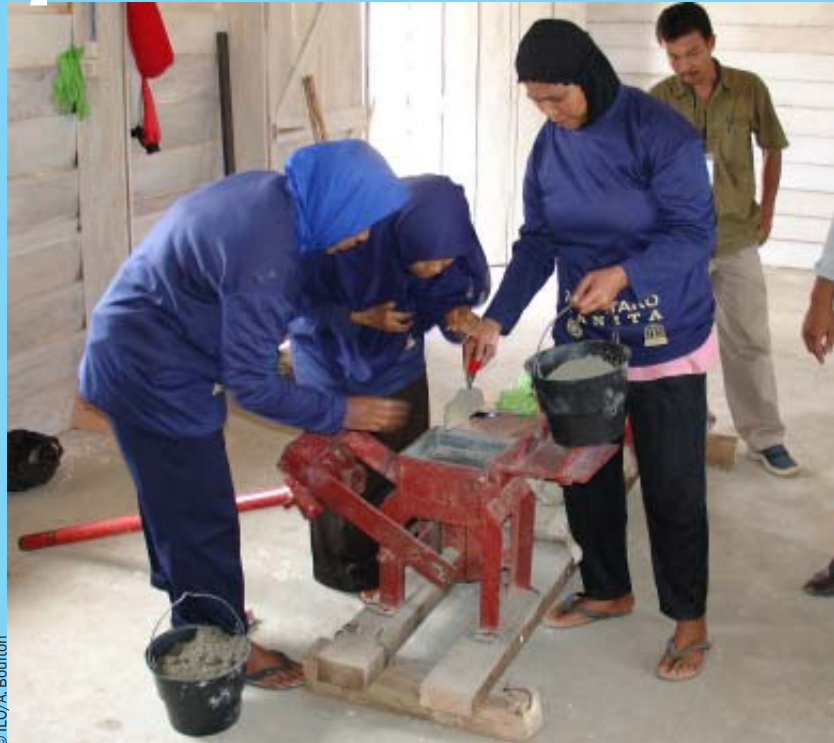
Tiga perempuan bahu-membahu memasukkan adonan semen ke dalam cetakan.
