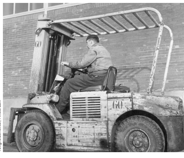
Figure 102.19 • Chariot élévateur à fourche équipé d'un toit de protection
