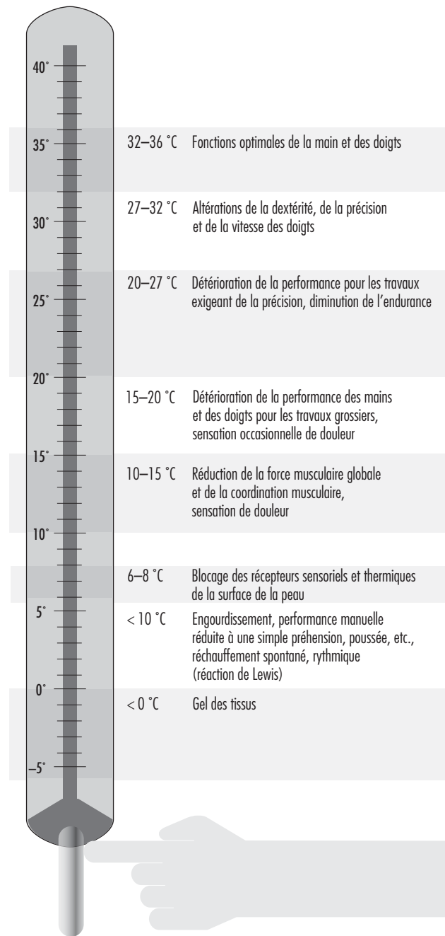
Figure 42.17 • Estimation des conséquences générales sur la performance manuelle des différentes températures de la main et des doigts
