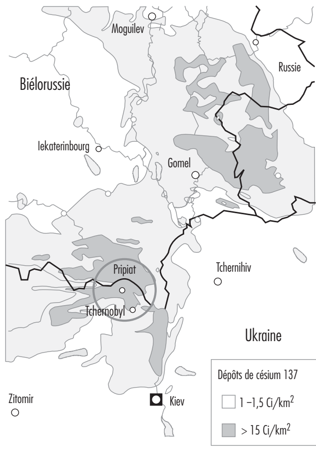
Figure 39.7 • Dépôts de césium 137 en Biélorussie, en Russie et en Ukraine après l'accident de Tchernobyl
