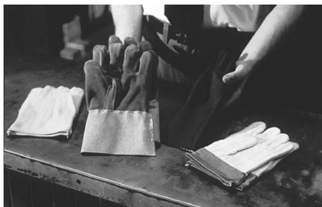
Figure 31.18 • Gants en fibres naturelles; la longueur doit en être suffisante pour assurer la protection des poignets
